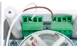
Фото 15. Подключение датчика к электроприводу
