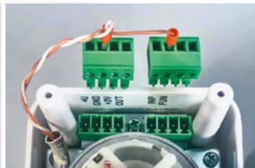
Фото 22. Подключение проводного выключателя
