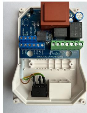
Фото 2. Блок управления GIDROLOCK STANDARD со снятой крышкой
